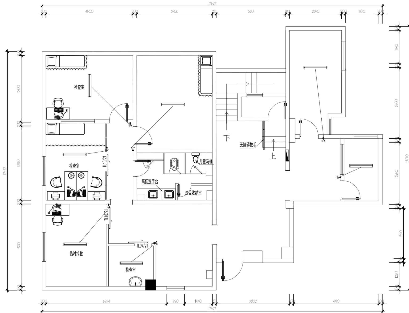
说明：无菌灯线路改造用2.5平方国标电线，原吊顶矿棉板吊顶内敷设，穿JDG20管，墙面2.0PVC明显槽敷设，开关明装
